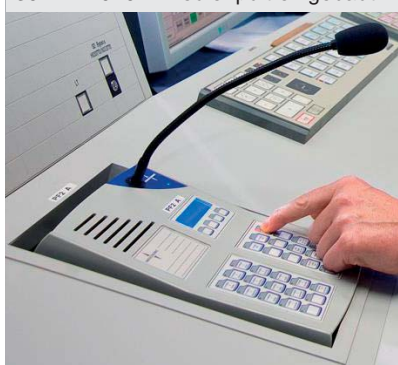
30 DTM 010 in Bedienpult eingebaut
