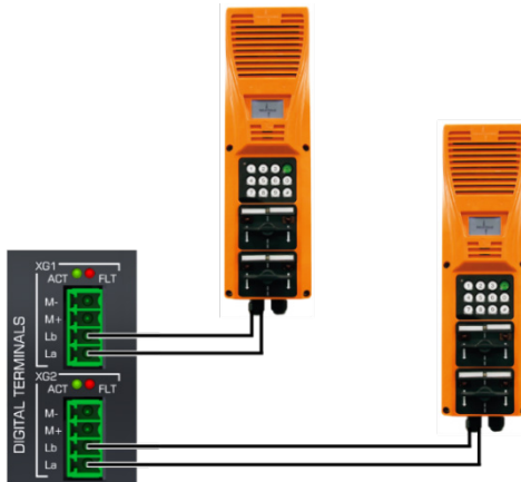
Abb. 6-1: Anschluss von zwei Endgeräten an La / Lb
