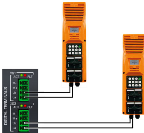
Abb. 6-2: Anschluss von zwei Endgeräten an L_a / L_b
