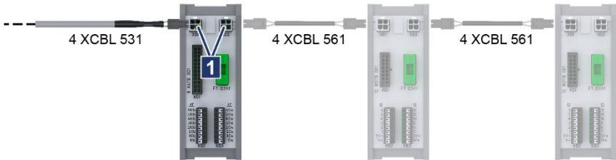
Abb. 6-5: Stromversorgung an XATB
