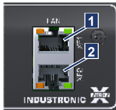
Abb. 6-7: Ethernet-Schnittstelle LAN ( XF1 und XF2 )
