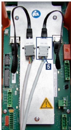
Abb. 15: NRO 1x2 mit zwei Ethernet-Schnittstellen
